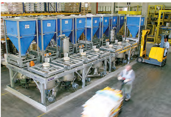
▼ Abb. 2: Container-Dosieranlage für 2 x 8 Klein-komponenten. Die Produktaufgabe erfolgt über ein Containersystem mit Zwischenbehältern, die mit Rührwerk-Austragapparat und Dosierschnecke mit Flow-Stop ausgerüstet sind
